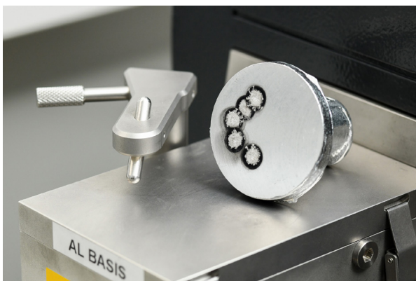
Schmelzanalyse mit Hilfe Optischer Emmissionsspektroskopie (OES), Foto: Fraunhofer IGCV
