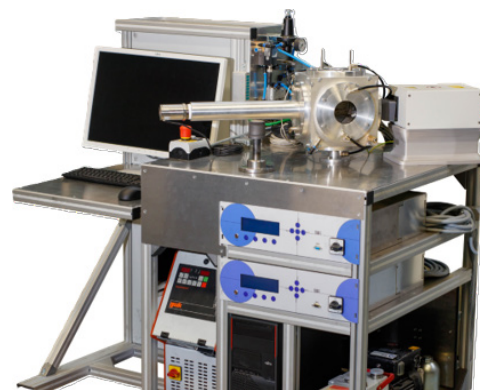
Abb: Versuchsaufbau Analyseofen mit Peripherie, Foto: ©utg
