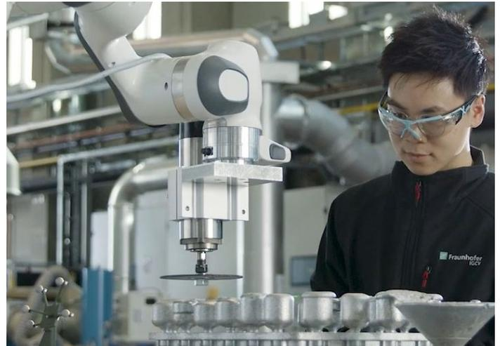
Roboter ausgestattet mit einer Trennscheibe zur Entfernung des Angussystems, Foto: ©FraunhoferIGCV
