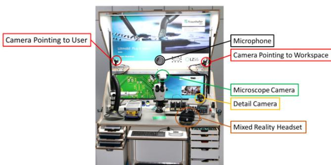
Abb: 1 Mobile Lötstation verbessert durch XR-Technologie,
