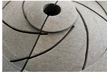
Abb. 1: Gedruckte Sandform: Formhälfte links: geglättete Oberfläche - Formhälfte rechts: konventionelle Stufen. Foto: FraunhoferIGCV, Iuva
