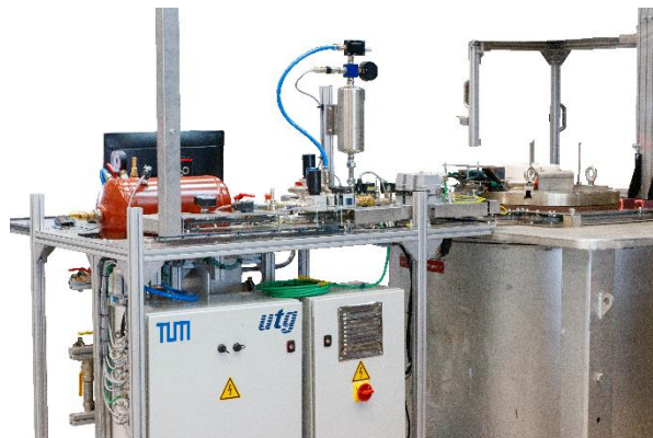
Abbildung 1: Forschungs-Niederdruckgießanlage zum Gießen von Kurzschlussläufern, Mindestgießzeit < 1 s bei mehr als 50 mbar/s
