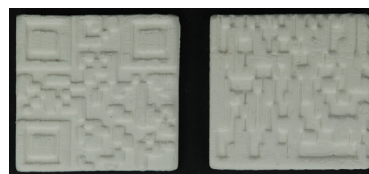
3D-gedruckte Barcode-Einleger ©Fraunhofer IGCV
