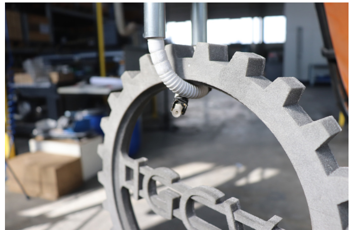
Durch den Demonstrator entpacktes Musterbauteil aus Sand, © Fraunhofer IGCV
