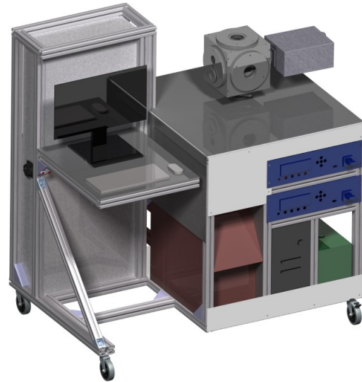
Abbildung 1: CAD-Modell des Gasentstehungsprüfstands. Auf der linken Seite befinden sich die Schaltschränke sowie die Peripherie des Messrechners. Rechts oben ist die Prozesskammer dargestellt, in der die Proben induktiv erwärmt werden. Darunter befinden sich Netzteile der Induktionsheizung, ein Wassertempertiergerät, der Messrechner sowie eine Vakuumpumpe.
