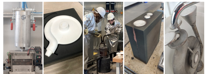
Prozesskette von links nach rechts: Kernschießen - fertiger, eingelegter Salzkern - Gießen - Erstarren - Entkernen durch Auslösen mit Wasser (Fotos: Fraunhofer IGCV)
