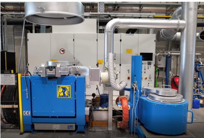
Induktionsgießanlage des Herstellers Otto Junker GmbH am Fraunhofer IGCV. ©Fraunhofer IGCV
