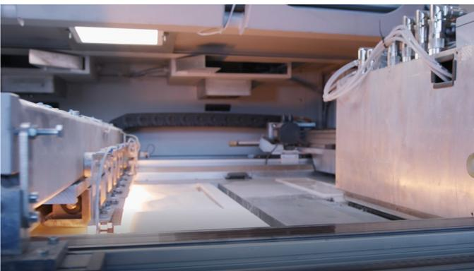
3D-Sanddruck zur Indirekten Additiven Fertigung am IGCV,
